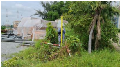
รูปที่ ง-10 ตรวจวัดค่าระดับการทรุดตัวอาคาร และหมุดหลักโรงไฟฟ้าฯ
