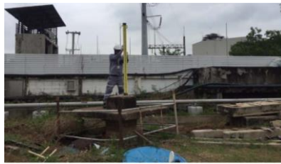
รูปที่ ง-10 ตรวจวัดค่าระดับการทรุดตัวอาคาร และหมุดหลักโรงไฟฟ้าฯ
